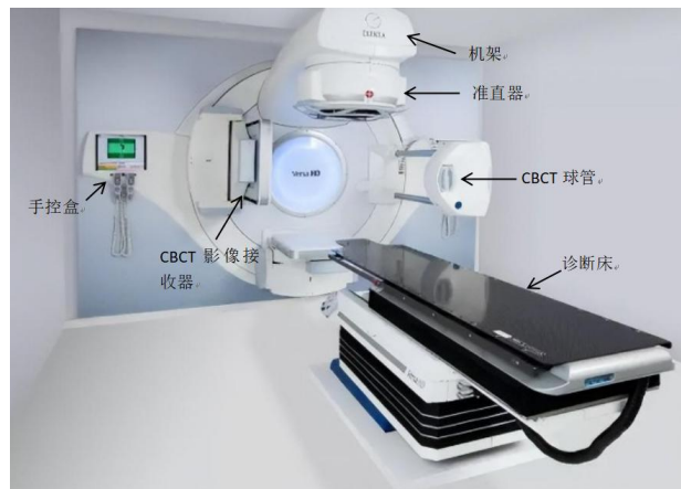
图 9-2 常见的医用直线加速器结构示意图
